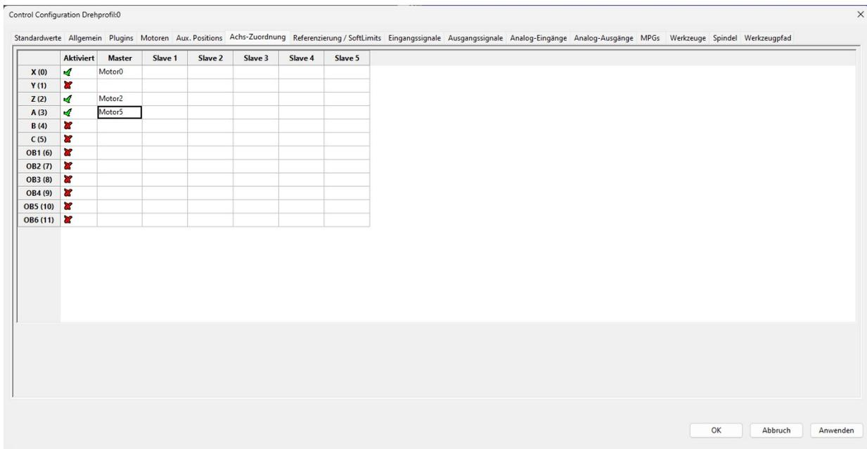
In Motoren Register wird Schritte/Einheit als 10 eingetragen. Das ist wichtig, sonst stimmen bei der Encoderauflösung des Servos nicht die 360°. Geschwindigkeit ist als 10000 und Beschleunigung als 1000. War ein guter Wert beim testen
